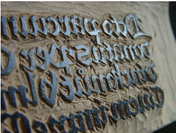
Rekonstruierte Holzplatte nach einem Einzelblatt aus Donatus: Ars minor (Basler Papiermühle; das Originalblatt stammt aus den Beständen der Universitätsbibliothek). Das Umkopieren geschah hier mit Hilfe einer Fotokopie auf Transparentfolie, die mit einfachem Holzleim auf die Birnbaumholzplatte geklebt und nach dem Trocknen unter Zurücklassung der Schrift von der Holzplatte abgezogen wurde. Beide Arbeitsmuster von KPS.
